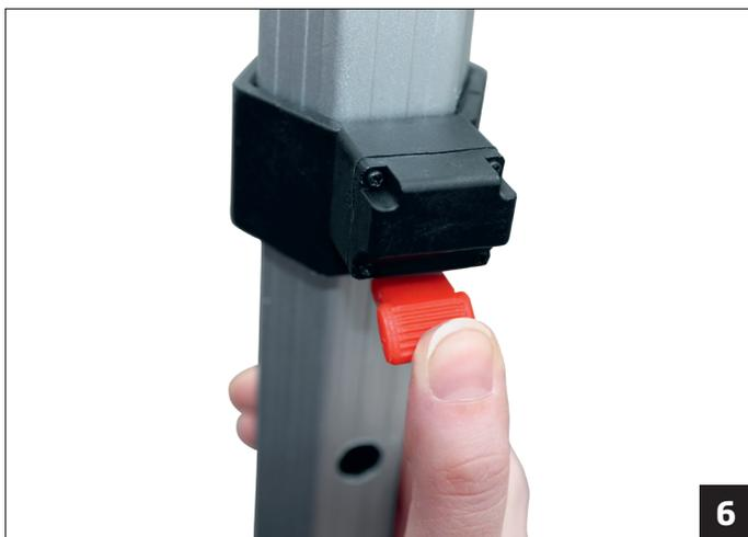
Presione hacia abajo los clips de plástico rojos de las barras telescópicas. Ahora el marco puede separarse completamente hasta que se encajen los pernos de bloqueo. La ayuda de otras personas (idealmente cuatro) es útil en este paso. Tire de las patas a la altura deseada hasta que encajen en su sitio.
