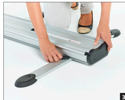
Gire la carcasa con todos los pies. Gire los pomos de sujeción ovalados de arriba y abajo de la carcasa hacia la derecha en el sentido de las agujas del reloj hasta que se encuentren en posición vertical respecto a la carcasa y se enganchen con la punta en la ranura de la carcasa. En caso necesario, puede anclar los pies al suelo con piquetes.
